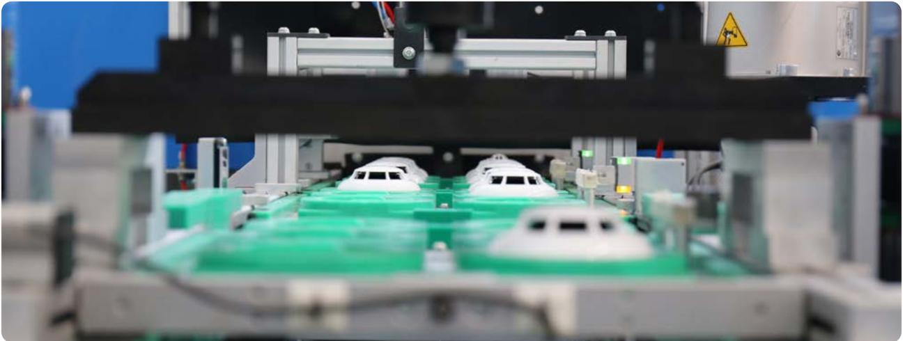
Los detectores, una vez ensamblados, se transportan mediante cintas de transporte dentro de la línea de calibración y prueba robótica. El primer tramo de la línea transporta los dispositivos con un robot cartesiano sobre un carrusel que realiza una primera serie de operaciones:
